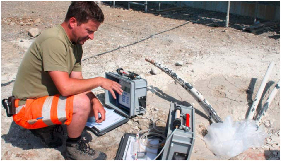
Bild 3: Beprobung des aus der Erdwärmesonde No. 20 ausströmenden Erdgases. Eine unmittelbar vor Ort durchgeführte erste Messung ergab einen Methananteil von über 91 %.
